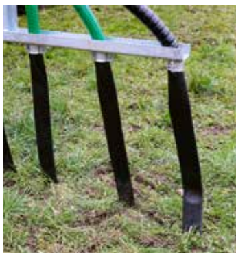
Separierte Gülle mit dem Schleppschlauch ausgebracht; minimale Futterverschmutzung und rasche Infiltration in den Boden.
