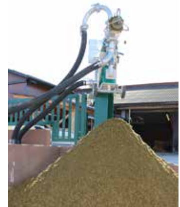
Fix implementierte Separatoren arbeiten weitgehend autonom und können PV-Strom nutzen.
