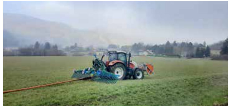
Separierte Gülle wird auf hofnahen Flächen und auf den Hanglagen der zweiten Hofstelle mit dem Schleppschuhverteiler verschlaucht.
