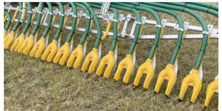
Mit Hilfe der „Duplo-Düse“ werden die abgelegten Güllebänder schlanker → weniger Futterverschmutzung
